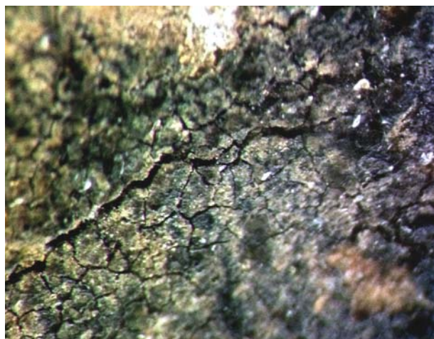
Ryc. 3. Silnie popękana powierzchnia substancji organicznej o znacznym stopniu degradacji termicznej - próbka Sr 903 (polaryzacyjny mikroskop optyczny PZO, powiększenie 200 X)
