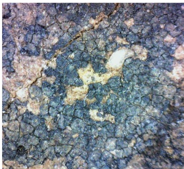
Ryc. 5. Znaczne spękania powierzchni substancji organicznej pod wpływem wysokiej temperatury - próbka Sr 903 (polaryzacyjny mikroskop optyczny PZO, powiększenie 120 X)
